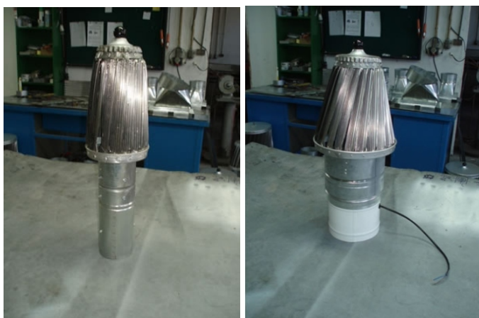
Wiatrowenty hybrydowe fi 100 i fi 200
